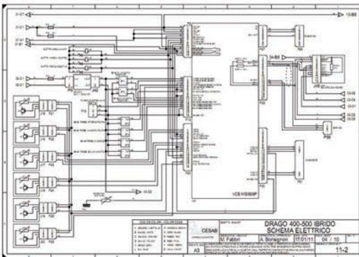
L'utilizzo di **SEE Electrical Expert** all'interno della progettazione elettrica di Cesab ha comportato diversi vantaggi: tra questi vanno evidenziati innanzitutto la possibilità di dividere i connettori ed i dispositivi su più fogli mantenendo un controllo di coerenza dei pin, la gestione automatica dei rinvii dei fili tra più fogli, infine il legame con il cablaggio fisico con possibile generazione automatica delle tabelle connettori, taglio cavo e distinta materiale.
